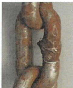
maglia con deformazione localizzata
