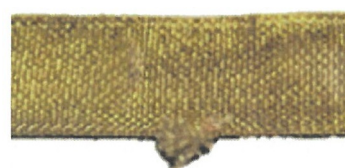
danneggiamento dei bordi
