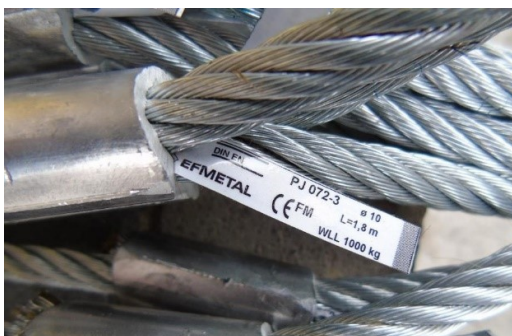
tipico formato della marcatura di una braca a funi metalliche
