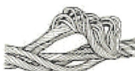
3 esempi di deformazione cosiddetta "a canestro" (birdcaging)
